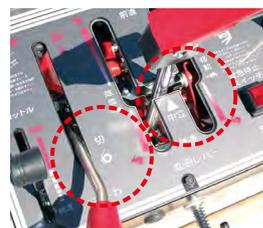
エンジン始動時の安全確保のため、変速レバーが「中立」と、オーガクラッチレバーが「切」の位置でのみエンジンを始動することができます。
