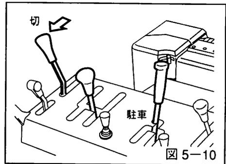
4. 引抜き式セーフティスイッチを「運転」の位置にセットします。
