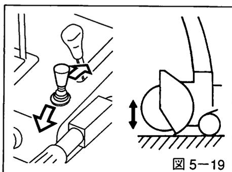
5. オーガクラッチレバーを「入」にゆっくり入れて、オーガとブロウを回転させます。この時、再度周囲をよく見回して、投雪方向に危険がないか確認してから、作業を行ってください。
